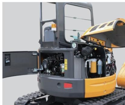
点検部品にダブルエアクリーナ、カートリッジ式リターンフィルタ、サイドバイサイドクーリングシステム、電気センサー付ウォータセパレータ、コントロールバルブを採用。右側カバーとエンジンカバー内に配置し、抜群の整備性を実現しました。
