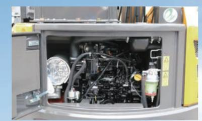
電子制御エンジンの搭載とオートアイドルを組み合わせることでクリーンな排ガスと低燃費を実現。環境にやさしい性能としています。
