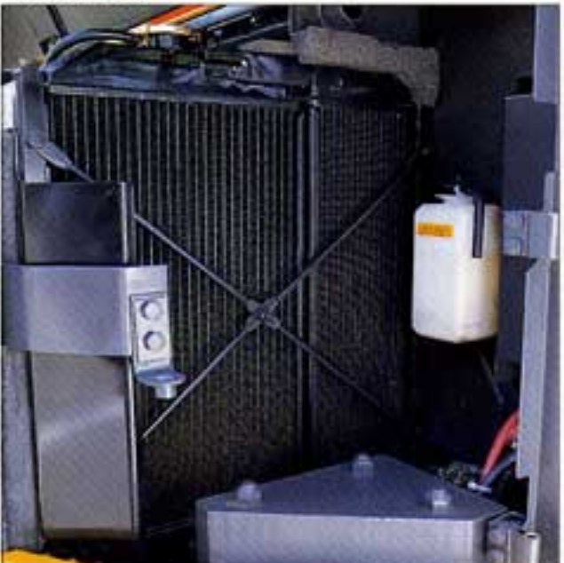
●作業油の寿命を延ばし、マシントラブルも防止。長時間ワークに頼もしい大型クーラを採用しています。
