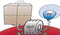
空気圧が低下すると、タイヤの負荷能力(支えることができる荷重)が低下します。車両に積載物を追加しなくても、空気圧が低下すると、タイヤにとっては「過荷重」状態になります。
