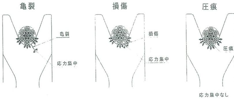
シープの亀裂、損傷も端部が鋭利な場合、応力集中が発生することにより亀裂の進行を促進する可能性があります。又、亀裂や大きな損傷（剥離）等はナイロンシープ成形時の不良等に起因している可能性があります。この場合は、シープの交換が必要になります。
