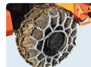
スリップを防ぎサイドウォールの保護も期待できるタイヤチェーン。ノーバンクタイヤの設定もあります。
