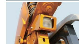
作業灯をシリンダロット部の破損にくい位置に配置しました。
