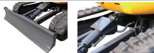
角管を採用し、頑丈で作業効率も良い、高さ380mmの大型排土板を採用しました。
