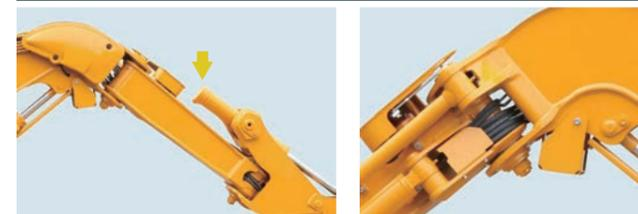
トラニオン位置を工夫し、シリンダの突き出しを防止。損傷にくくしました。
