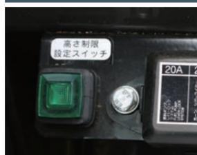
便利なブーム高さ制限機構を採用しました。電線など上方向に障害物のある現場での作業性が向上します。
