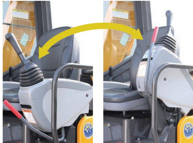
誤操作を防止するゲートロックレバーを採用しました。ゲートロックレバーをはね上げ時、バケット、アーム、ブーム、旋回、走行、排土板、ブームスイングのすべての操作がロックされます。
