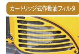
さびに強いアルミ製のラジエータ、オイルクーラを採用しました。また、作動油フィルタはカートリッジ式なので交換が簡単です。
