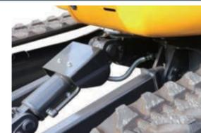
排土板シリンダーホースに分割式を採用し、破損時の交換が楽に行えます。
