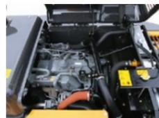
排出ガス後処理システム(SCR)によりNOxを大幅に削減。排出ガスをクリーンにします。PM(粒子状物質)の大幅低減、NMHC(非メタン炭化水素)の低減も同時に行い、特定特殊自動車排出ガス 2014年基準に適合しています。さらに環境にやさしい性能としています。
