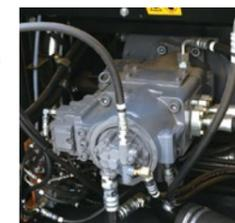
**油圧配管の大径化で圧力損失を低減**
