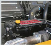
排出ガス後処理ユニット(DOC+DPF+SCR)によりPM、NOxを大幅に削減。排出ガスをクリーンにします。
