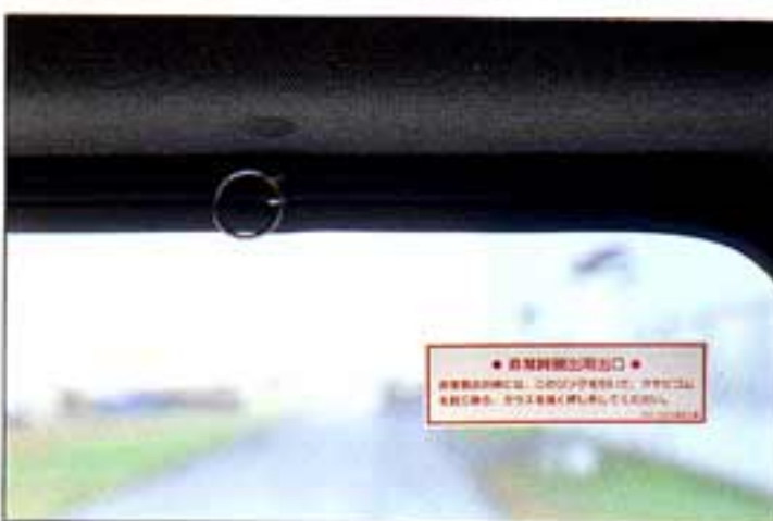
●非常時の後方脱出口。
