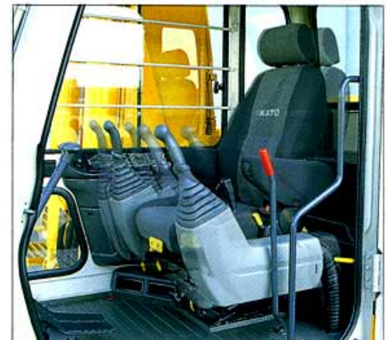
● コンソールと一体でスライドするオペレーターシート。
