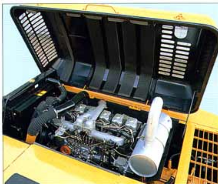
●高出力で低燃費・低騒音、タフで粘り強い173kW{235PS}直噴ターボエンジン。
