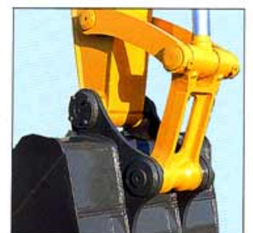
●バケットのガタを簡単に調整できるクリアランス調整機構。
