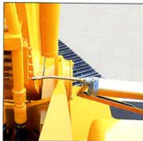
●給脂作業が効率的にできる集中給脂方式。
