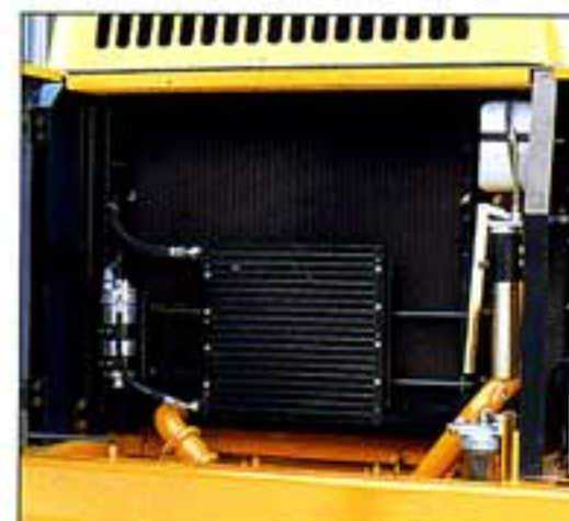
●ラジエータには目詰まりしにくい防塵ネットを装備。 (写真はエアコン装備車)
