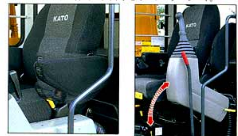
● オペレータの体格に合せたポジションが得られるアームレスト角度調整機構。
