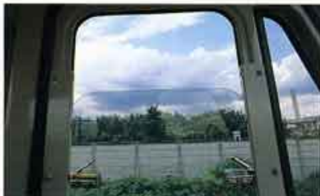
●直射日光をカットし、まぶしさを防止するブロンズガラス
