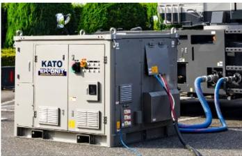
当製品は外部電源油圧ユニット「EK-UNIT」を標準付属品としています。これにより、電源確保が可能な建設現場では、電力のみでクレーン作業を行うことが可能です。
