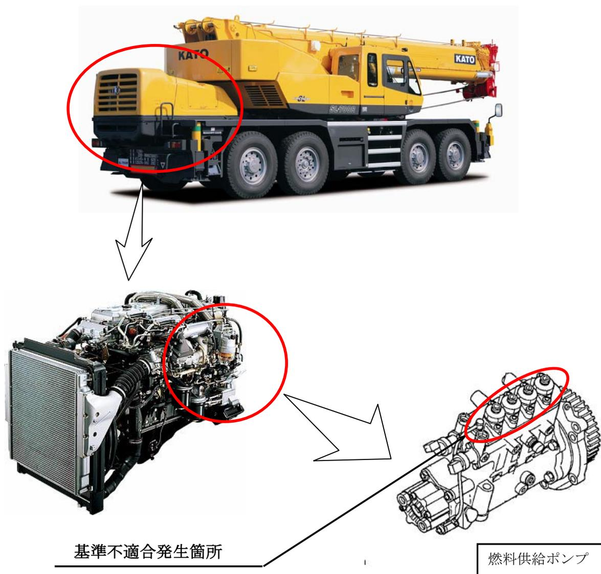
燃料噴射装置において、燃料供給ポンプの製造時の加工が不適切なため、当該ポンプの内部に亀裂が発生し、燃料が漏れ、エンジンオイルに混入するものがある。そのため、そのままの状態で使用を続けると、燃料の混入したオイルがブローバイガスの通路を経由して吸気管に吸入されシリンダー内で燃焼するため、エンジン回転の上昇、エンジン停止及び再始動不能となり、最悪の場合、燃料の混入したエンジンオイルが漏れ火災に至るおそれがある。
