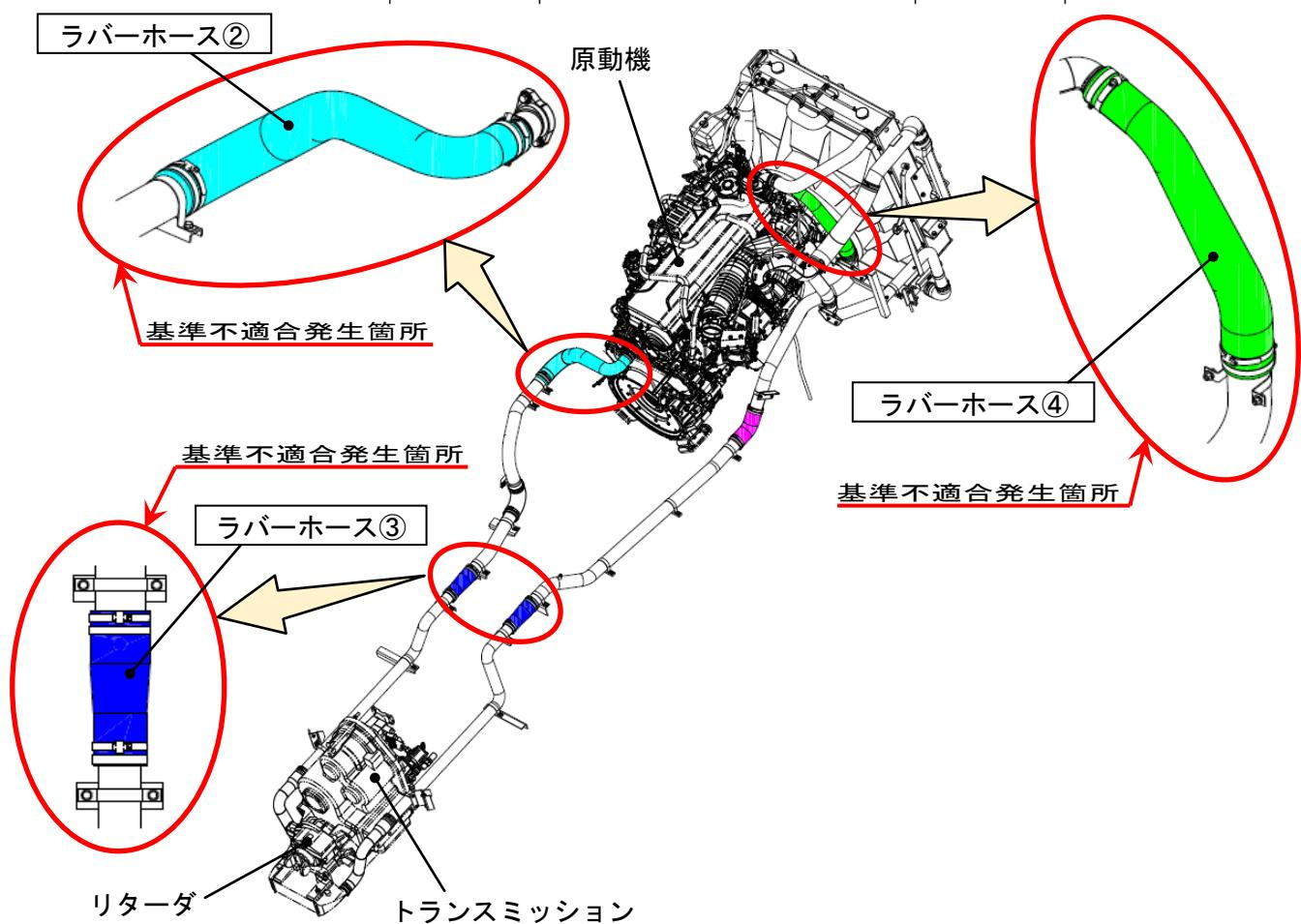
原動機冷却装置において、リターダ冷却装置のラバー ホースの強度が不足しているため、当該ラバー ホースが破損するものがある。そのため、そのまま使用を続けると、ラバー ホースから冷却水が漏れて、最悪の場合、エンジンが停止し走行不能になるおそれがある。
