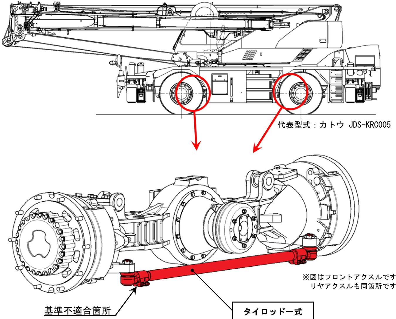
ホイール・クレーンのかじ取り装置において、タイロッドエンドのクランプボルトの締め付けトルクが不適切なため、締め付け力が低下するものがある。そのため、タイロッドエンド部のねじ部にガタが生じ、そのままの状態で使用を続けると、タイロッドエンド部のネジ山が損傷して、最悪の場合、タイロッドエンド部からタイロッドが抜けて操舵不能になるおそれがある。
